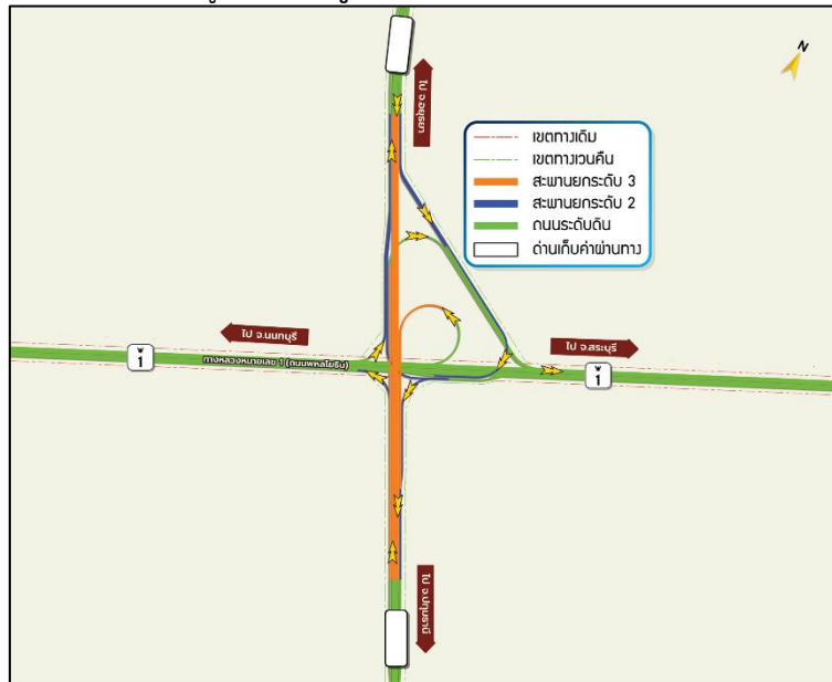
รูปที่ 26 รูปแบบทางเลือกทางแยกต่างระดับบริเวณจุดตัดทางหลวงหมายเลข 1 รูปแบบทางเลือกที่ 1
