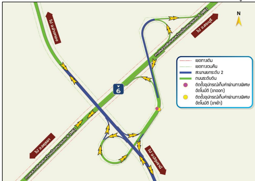
รูปที่ 25 รูปแบบทางเลือกทางแยกต่างระดับบริเวณจุดตัดทางหลวงพิเศษระหว่างเมืองหมายเลข 6 รูปแบบทางเลือกที่ 3
