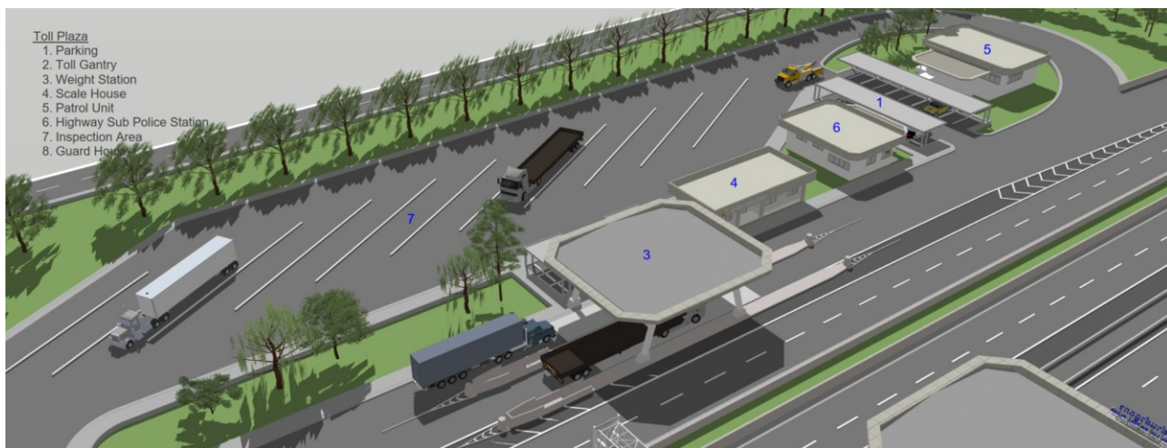
รูปที่ 34 อาคารสถานีตรวจสอบน้ำหนัก
