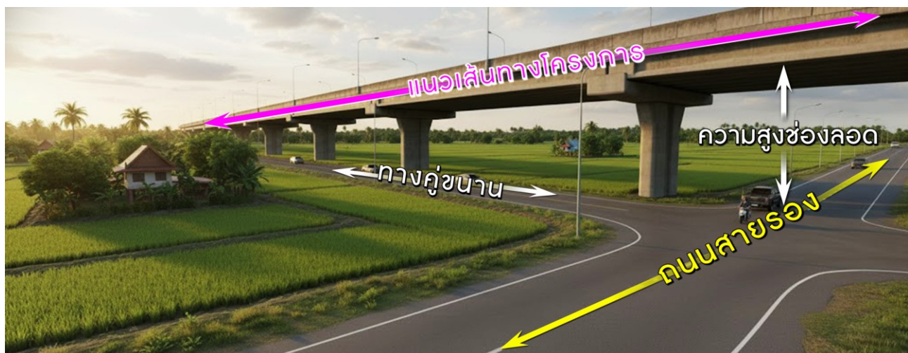
รูปที่ 16 จุดเชื่อมต่อทางคู่ขนานและทางลอดของโครงการ
